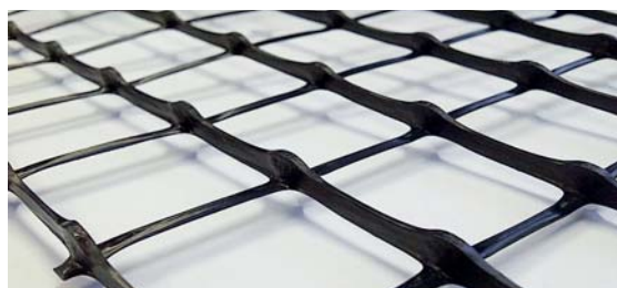
Obr. 3: Vysoké žebro a spoje (4, 5 a 6 mm) výrazně napomáhají zaklínění zrn; sečnová tuhost 550 kN
