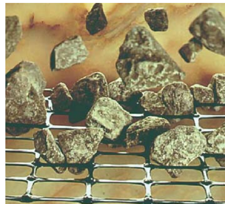
Obr. 1: Princip zazubění záspy do otvorů geomříže a jejich spolupůsobení
